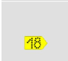
Auf der Berninabahn werden Hindernisse für die Schneeräumung durch gelbe Tafeln angezeigt. Die Zahl gibt den Abstand zum Hindernis von der Gleismitte in Pfeilrichtung an (in dm, z.B. 18 = 1,8 m). Diese Tafeln findet man auf Brückengeländern, Fahrleitungs- und Signalmasten etc.
