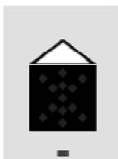
Signale mit einem weißen, dreieckigen Aufsatz sind in unbeleuchtetem Zustand ohne Bedeutung.
