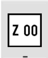
Diese Tafel weist draufhin, den nur im Bereich der Zürcher S-Bahn vorhandenen Z-Kanal abzuschalten, um Störungen in anderen Funknetzen zu vermeiden.
