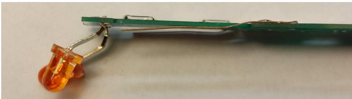
Bild: Die beiden LEDs müssen etwas unterschiedlich gebogen werden. Hier sieht man auch, dass die Stromabnahmebleche einen leichten Zickzack nahe der Lötstelle bekommen.
